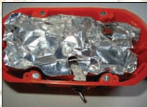
ИЗ КУСКА ФОЛЬГИ ПОЛУЧИТСЯ ОТЛИЧНЫЙ ОТРАЖАТЕЛЬ. НАДО, ЧТОБЫ НИЧЕГО НЕ ЗАКОРОТИЛО. ОСТАЛОСЬ ТОЛЬКО ПОЛОЖИТЬ СВЕРХУ КУСОЧЕК БЕЛОЙ БУМАГИ, ЧТОБ СВЕТ РАССЕИВАЛСЯ.
