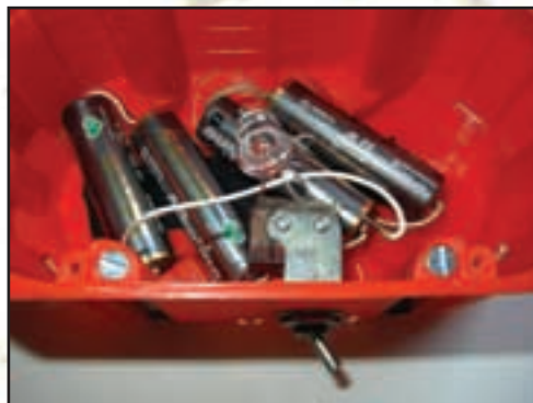
ЧТОБЫ СМОНТИРОВАТЬ ВСЕ В КОРОБКУ, НАДО ПРОРЕЗАТЬ НОЖОМ В СТЕНКЕ ДЫРИЩУ ПОД ПЕРЕКЛЮЧАТЕЛЬ. БАТАРЕЙКИ МЫ НАЛЕПИМ НА ДВУСТОРОННИЙ СКОТЧ, ЧТОБ НЕ ВЫПАЛИ.
