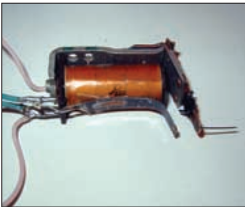
ПОСЛЕ ТОГО КАК МЫ УДАЛИЛИ ЛИШНИЕ ДЕТАЛИ, ПРИКРЕПИЛИ ИГЛУ И ПОДПЯ- ЛИСЬ - ПОЛУЧИЛОСЬ ВОТ ЭТО.
