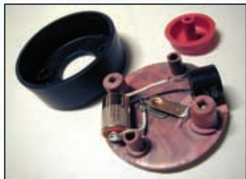
ТАК ДЕЛАЮТ ПИЩАЩИЙ ЗВОНОЧЕК. ЭТОТ МАЛЕНЬКИЙ ЧЕРНЕНЬКИЙ ЭЛЕМЕНТ - ПЬЕЗОГЕНЕРАТОР ЗВУКА. ОЧЕНЬ ПРОТИВНО И ГРОМКО ПИЩИТ. ВСЕ СИЛЬНО ПУГАЮТСЯ, КОГДА НАДАВЯТ НА ЦАПУ.
