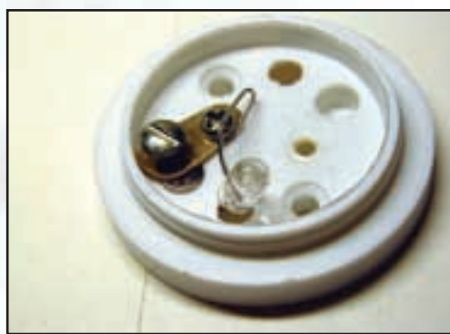
Рис. 2 Кнопка звонка со звуковой реакцией на нажатие
