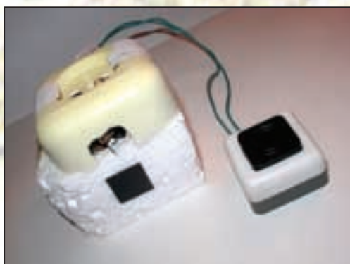
ИЗ ЭТОЙ БЕЛОЙ КОРОБКИ РЕЗКО ВЫЛЕТАЕТ ИГЛА, ЕСЛИ НАЖАТЬ НА КНОПКУ. ОНА ДАЖЕ ВПЛИВАЛАСЬ ХОЛОДУ В ПАЛЕЦ. ЧТОБЫ ИГЛА ВЫСКОЧИЛА, ЕЕ НАДО СНАЧАЛА ТУДА ЗАРЯДИТЬ. ИГЛА ПРИВЯЗАНА К ЯКОРЮ, ТАК ЧТО ВЫЛЕТАЕТ ОНА ТОЛЬКО НА САНТИМЕТР.
