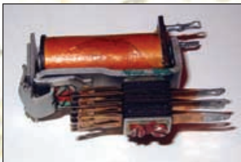
КУСОК ОРИГИНАЛЬНОГО РЕЛЕ МЫ НАШЛИ НА ПОМОЙКЕ. ТУТ ОСТАЛОСЬ ТОЛЬКО УДАЛИТЬ ПЛАСТИНЫ КОНТАКТОВ.
