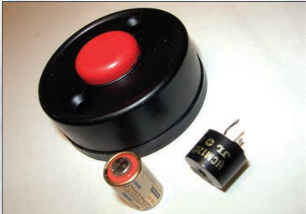
ТАК ДЕЛАЮТ ПИЩАЩИЙ ЗВОНОЧЕК. ЭТОТ МАЛЕНЬКИЙ ЧЕРНЕНЬКИЙ ЭЛЕМЕНТ - ПЬЕЗОГЕНЕРАТОР ЗВУКА. ОЧЕНЬ ПРОТИВНО И ГРОМКО ПИЩИТ. ВСЕ СИЛЬНО ПУГАЮТСЯ, КОГДА НАДАВЯТ НА ЦАПУ.
