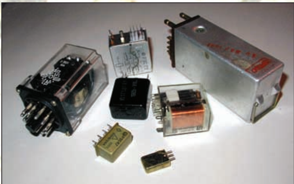
ТАК ВЫГЛЯДЯТ РЕЛЕ. НАМ НУЖНЫ ТЕ, ЧТО ПОКРУПНЕЕ. К МЕЛКИМ СЛОЖНО ПОДСОЕДИНИТЬСЯ.
