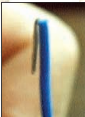
ТАКИМ ОБРАЗОМ ЗАГИБАЕТСЯ ЗАЩИЩЕННЫЙ КОНЕЦ ПРОВОДА
